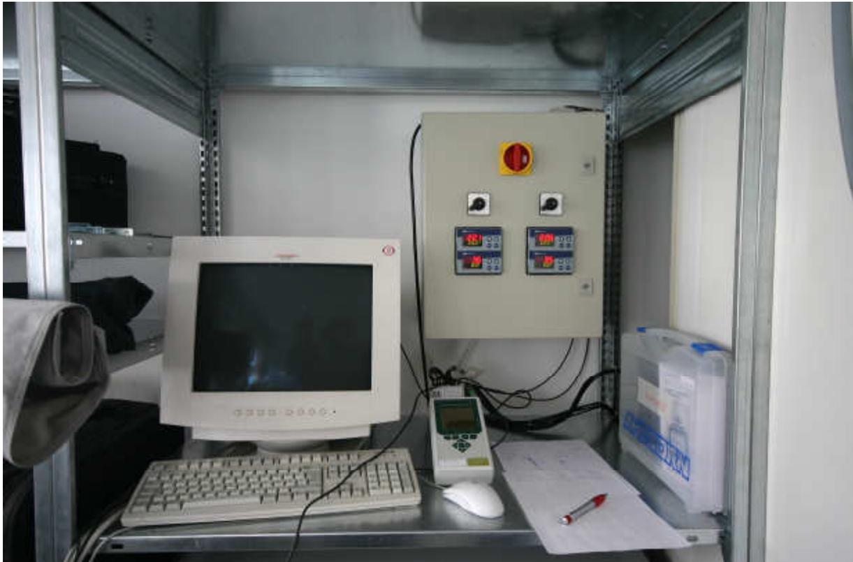
**Abbildung 18: Datenerfassung und Regler des Differenzklimakammer-Prüfstandes**
