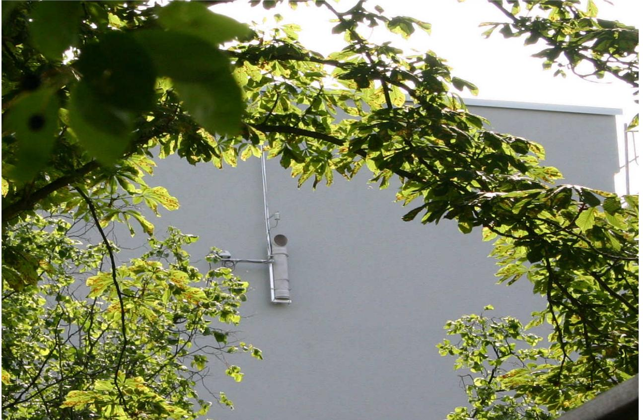
**Abbildung 8.: Fassadenstativ mit Schlagregensammler, der vom 21.08.2007 bis 10.01.2008 neben dem elektronischen Regenmesser die Schlagregenbelastung der Fassade erfasste. Links der Ausleger mit dem elektronischen Regenmesser.**
