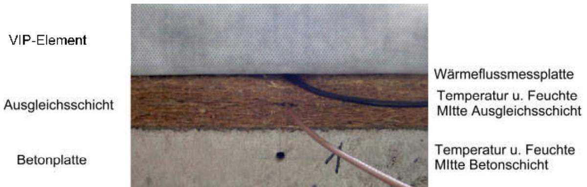
Abbildung 23 Schichtaufbau und Sensorpositionen im Probenkörper
