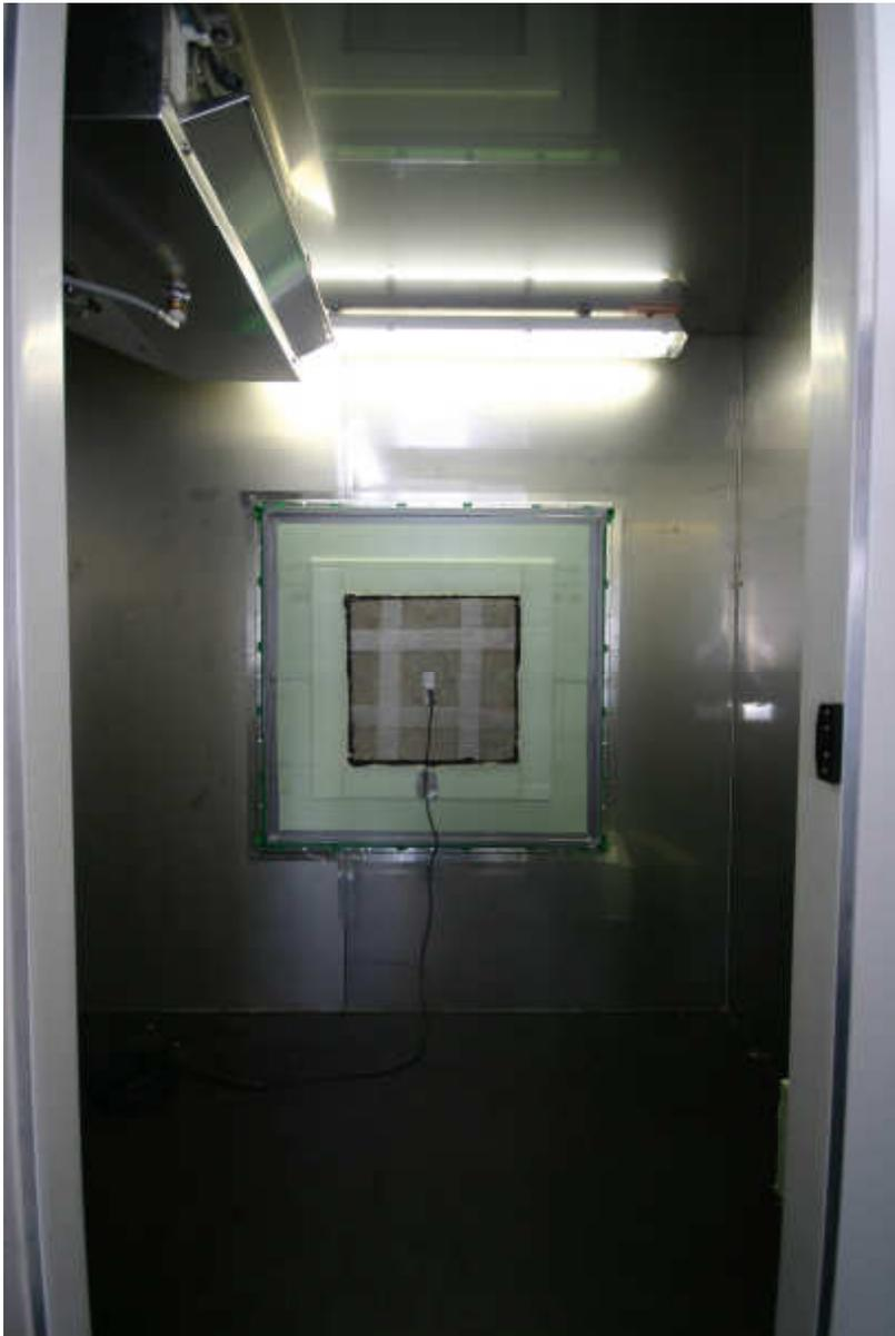
**Abbildung 22: Blick in die „kaltseitige“ Hälfte der Klimakammer mit fertig eingebauter Probe und Oberflächentempersensoren auf der Betonplatte**
