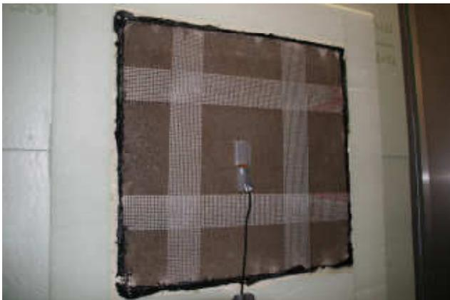
**Abbildung 26: Kaltseite Probenkörper, Betonoberfläche nach dem Befeuchtungsexperiment**
