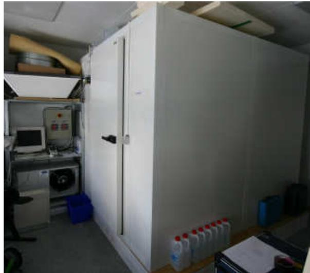
**Abbildung 19: Differenzklimakammer-Prüfstand (Klima 1: „Außenklima bzw. Kaltseite“, Klima 2: „Innenklima bzw. Warmseite“)**
