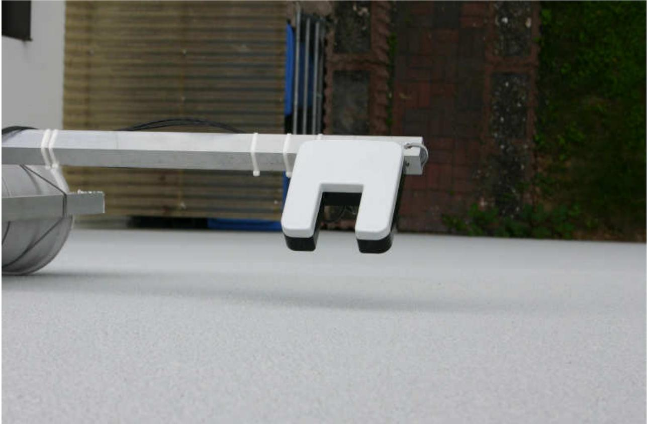
**Abbildung 3. Elektronischer Regenmesser an Stativ vor der Außenoberfläche**
