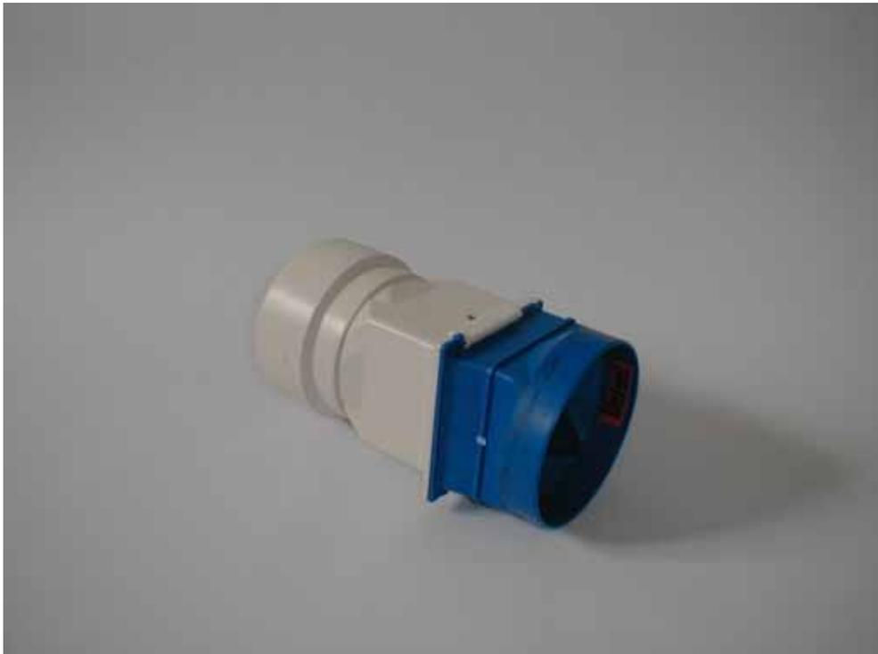
Die Rückholfeder lässt sich in zwei Stellungen fixieren, lt. Hersteller wird die Klappe mit der schwächeren Federeinstellung ausgeliefert. Dies ist auch der für einen geringeren Druckverlust gewünschte Einbauzustand. Für die Funktion der Klappe ist die Federstellung unerheblich, da die Klappe bei Gegenströmung durch andere Ventilatoren auf jeden Fall geschlossen wird.
