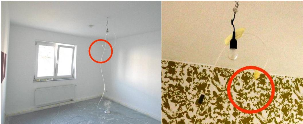
**Abbildung 4: Luftprobenahme bei der Indikatorgas-Messung über ein Schlauchsystem**
