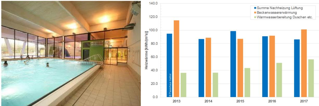
Abb. 1: Becken im Lippe-Bad Lünen und Messwerte zum Langzeitverbrauch des Bades am Beispiel des Wärmeverbrauchs (Bezug: Gesamte beheizte Fläche des Bades).
