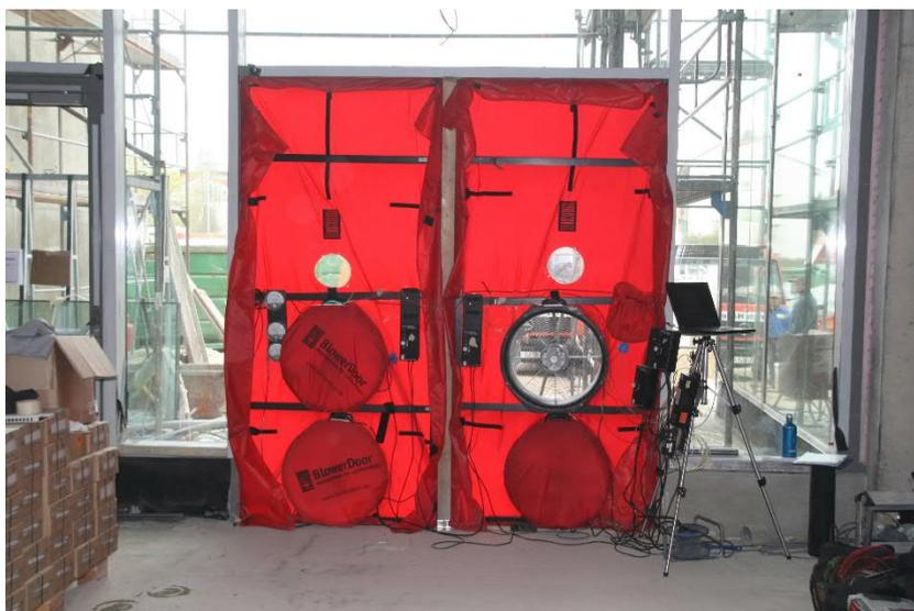
**Abb. 8** Luftdichtheitsmessung des Bambados: Auf Grund der sehr guten Luftdichtheit konnte das gesamte Gebäude mit nur einem Ventilator gemessen werden.
