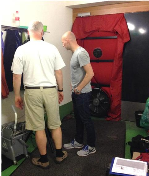
**Abb. 22:** Eingebaute Blower Door in der Außentür des Anlieferbereichs während der Unterdruckmessung zur Leckagesuche am 04. Mai 2016.
