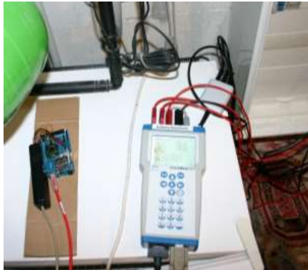
Abbildung 87: Hochgenauer Stromzähler zur zeitaufgelösten Messung des Gesamtstromverbrauchs am Zählerkasten.
