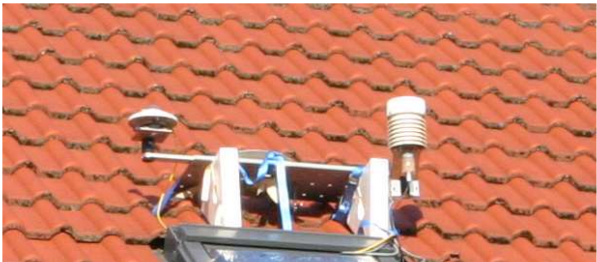
Abbildung 26: Wetterstation während der Messung am Reihenendhaus (Arheilgen). Links Pyranometer, rechts Aspirator/Strahlungsschutz für Lufttemperatur/-feuchte Messung. Das Pyrgeometer befindet sich in der Mitte (nur Rand erkennbar).
