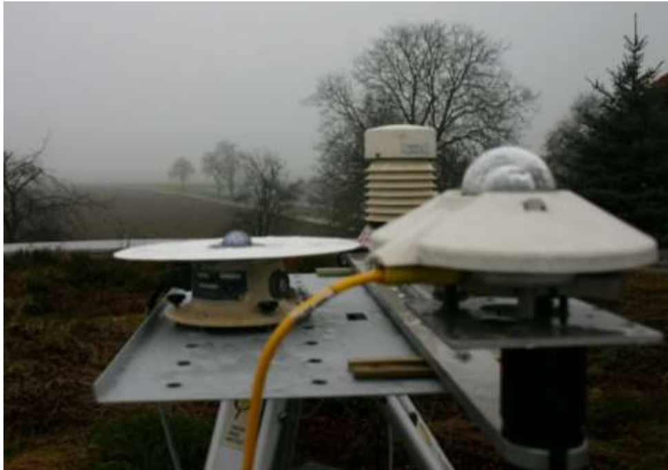
Abbildung 79: Wetterstation auf dem Dach des Messobjekts. Das Foto liefert auch einen Eindruck der Wetterbedingungen während eine Großteils des Messzeitraums.
