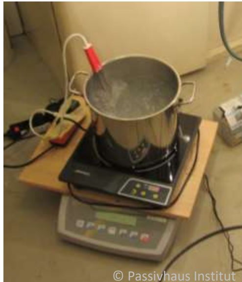
Abbildung 28: Messaufbau zur Verdampfung von Wasser für das Feuchteexperiment. Mit der Waage wurde die Menge des verdampften Wasser gemessen.
