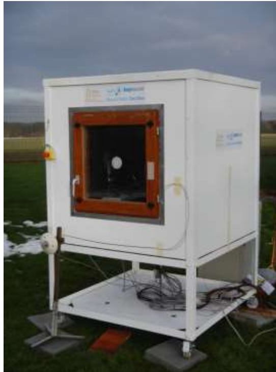
Abbildung 9: Foto der Round-Robin-Testbox während der Messung im Januar/Februar 2013 (Bild: KU Leuven)
