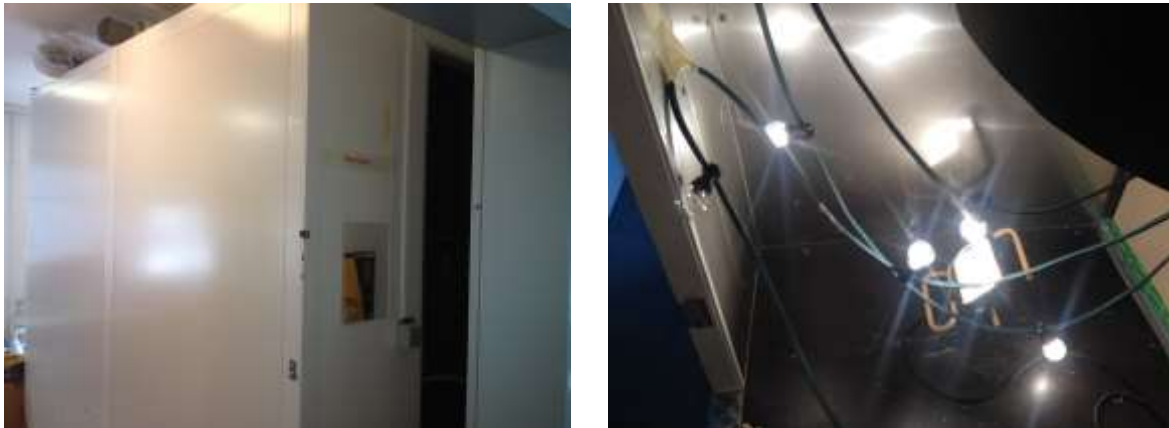
© Passivhaus Institut © Passivhaus Institut Abbildung 30: Außen- (links) und Innenansicht der Klimakammer während der Messung mit eingeschalteten Heizelementen.
