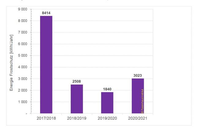
Abbildung 12: Absoluter Energieverbrauch für das Frostschutzregister in vier Jahreszeiträumen (jeweils Juni bis Mai des Folgejahres). Deutliche Reduktion durch Veränderung der Einstellwerte (Grenztemperatur).
