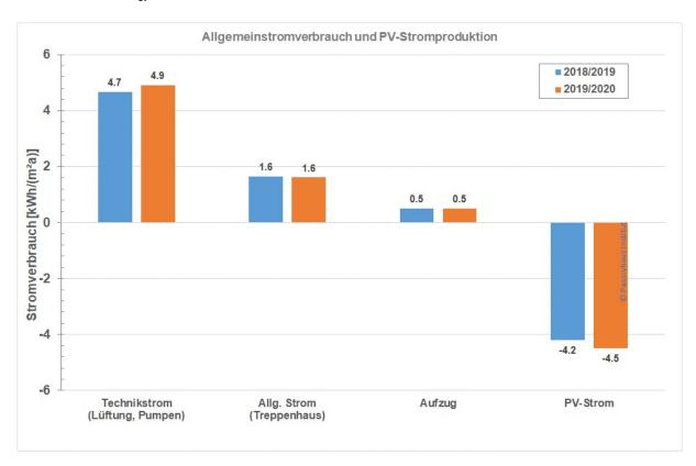
Abbildung 21: Allgemeinen und gemeinschaftliche spezifische Stromverbrauchswerte im Gebäude in zwei Messjahren. Zusätzlich ist der Stromertrag der PV-Anlage auf dem Hausdach aufgetragen (Einspeisung = negativer Verbrauch).
