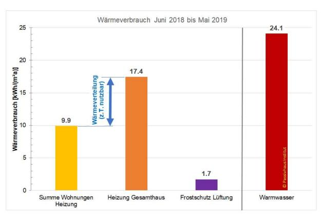
Abbildung 15: Wärmeverbrauch im Gebäude für die unterschiedlichen Verbrauchsbereiche (Beispielhaft: Juni 2018 bis Mai 2019). Der Unterschied des Heizwärmeverbrauchs des Gesamthauses gegenüber der Summe der Verbräuche der 16 Einzelwohnungen erklärt sich in der Hauptsache durch die Wärmeverteilung. Diese ist zum Teil nutzbar und zum Teil nicht nutzbar (Verluste).
