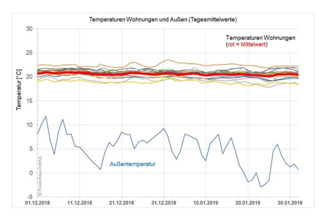
Abbildung 4: Ausschnitt aus dem Verlauf der Raumtemperaturen der 16 Wohnungen sowie der Außentemperatur im Winter 2018/2019. Der Mittelwert der Wohnungen (rot) ist flächengewichtet.
