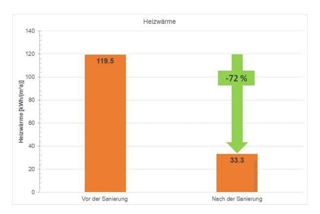
Abbildung 95: Gemessener Heizwärmeverbrauch vor und nach der Sanierung des Gebäudes.
