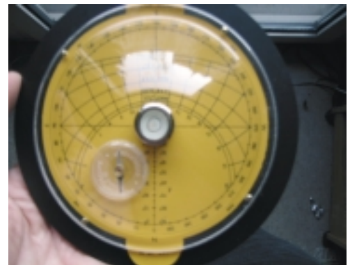
Abb. 4 Projektionsebene des Horizontoskops mit Sonnensandskala (oben) [43] [44]. Horizontlinie der benachbarten Bebauung bzw. Bepflanzung bei Blick Richtung Süden (oben rechts). Schattenwurf der Horizontlinie auf der Glas-kugel, senkrecht projiziert auf die „Sonnensandskala“ des Horizontoskops. Demnach ist an diesem Standort im Winter (November und Dezember) Besonnung nur zwischen 10 Uhr und 13 Uhr gegeben. Fotos: PHI
