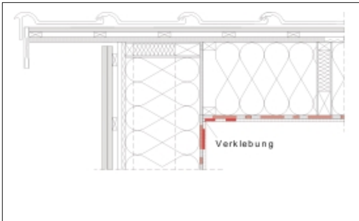
Abb. 40 Anschlussdetail Ortgang, Holz-Leichtbau Wand und Dach [63] U_{\text{Wand}} = U_{\text{Dach}} = 0,12 \text{ W}/(\text{m}^2\text{K}) \Psi_a = -0,055 \text{ W}/(\text{mK}) Grafik: PHI
