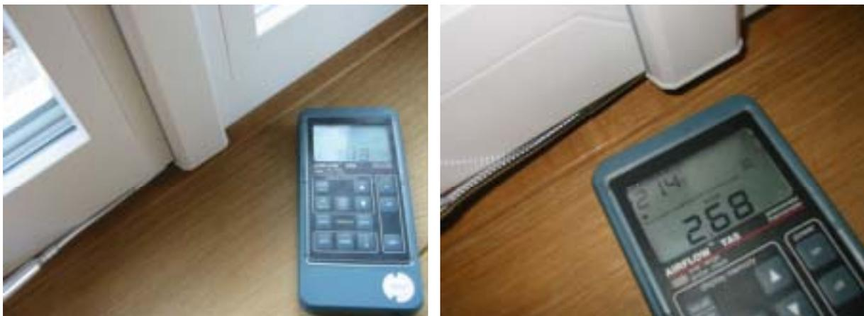
**Abbildung 19:** Leckageortung beim Blower-Door-Test. Undichtheit am Stulp der doppelflügligen Fenster.
