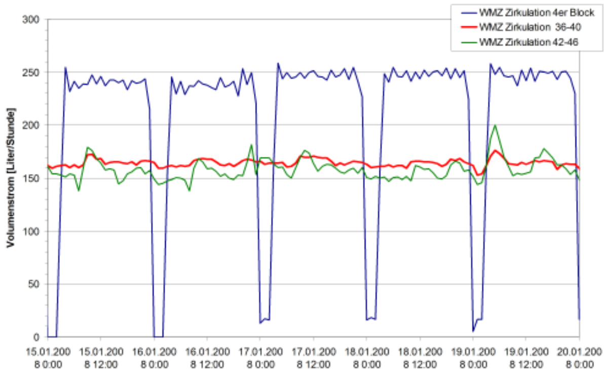
Abbildung 58: Volumenstrom der Zirkulationsleitung der drei Anlagen in den beiden Gebäuden in der Beispielzeit 15.01.2008 bis 19.01.2008 (Stundendaten).
