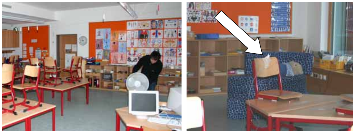
Abbildung 127: Links: Verteilen des Tracergases mit einem Ventilator. Rechts: Ansaugstelle im Raum (Schlauch an der Rückenlehne eines Stuhls).
