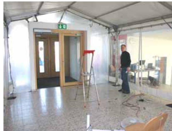
Abbildung 147: Messzelt von innen. Zur Minimierung der Leckagen zum Foyer wurden die Stöße und Anschlüsse des Zeltaufbaus sorgfältig abgeklebt. Über ein Schlauchsystem werden Luftproben aus dem Zeltvolumen entnommen. 2 Schlauchenden sind mit Kreisen markiert (links). Der Ventilator (links) sorgt für eine gute Durchmischung der mit Indikator angereicherten Luft im Zeltvolumen.
