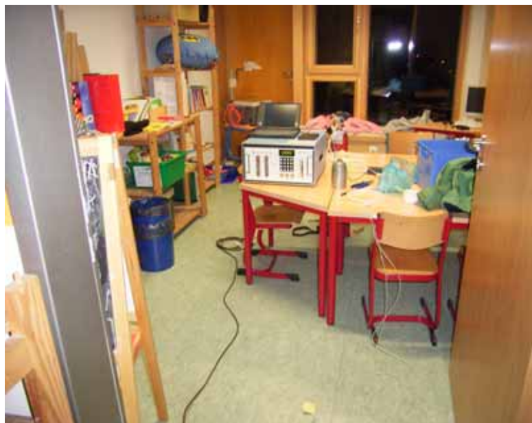
Abbildung 126: Tracergasmonitor im Gruppenraum neben einem Klassenraum.
