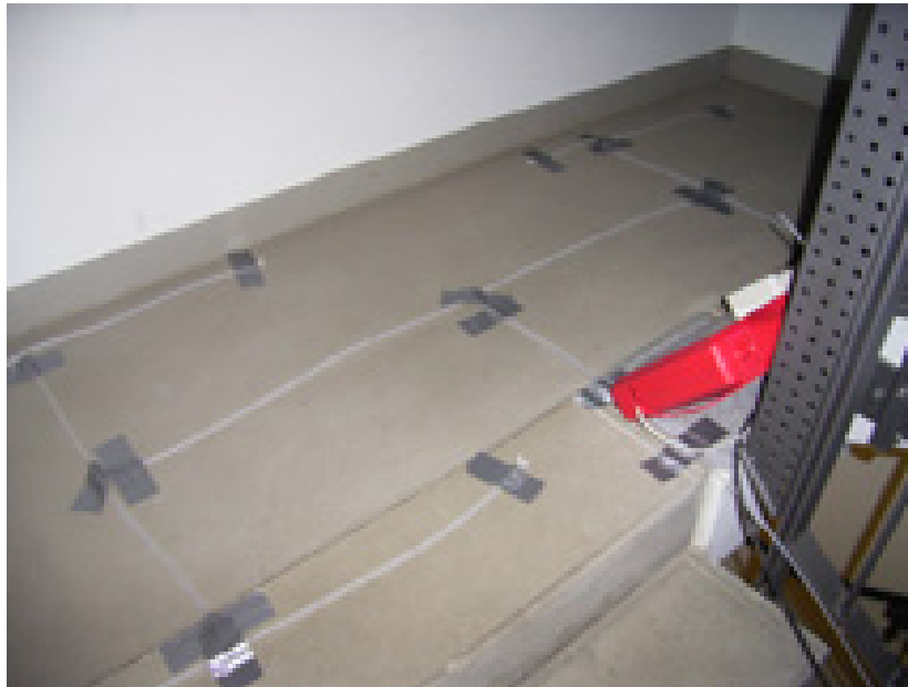
Abbildung 108: Einbringung der Tracers im Treppenhaus
