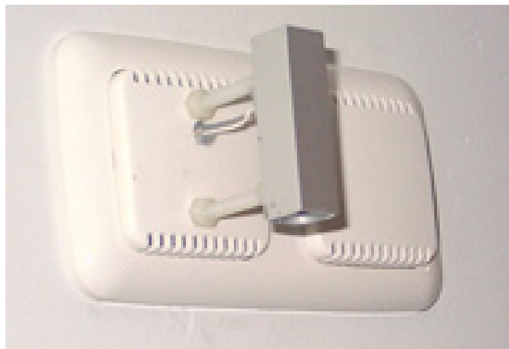
Abbildung 50: Doppelte Temperatursensoren für Oberflächen- und Raumlufftemperaturmessung (mit Alu-Strahlungsschutz). Im oberen Bild ist im geöffneten Zustand die Elektronik sichtbar.
