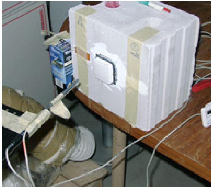
Abbildung 53: Aufbau der Kalibriermessung mit einem Wohnungs-Temperaturmodul, eingebaut in einer UP-Dose im Kalksandstein. Die Referenz-Temperatur Sensoren sind auf dem Stein fixiert (orange) bzw. an dem schwarzen Ständer vor dem Modul fixiert.
